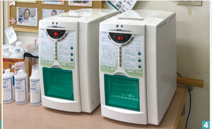
2 「FIND」は機器前面のボタンで、おしぼりの長さや温度、湿り具合、本数などを細かく調整することができる 4 「FIND」はナースステーションなどに設置。設置工事は不要で、電源プラグをコンセントに差し込むだけで使用可能
